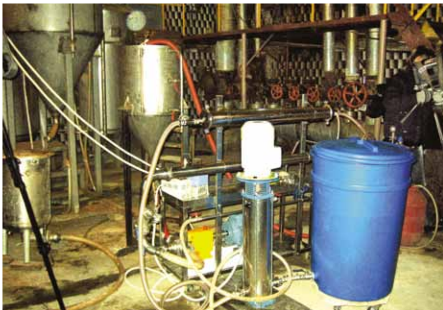
Рис. 2. Общий вид опытно-промышленной мембранной установки производительностью 200 л/ч
